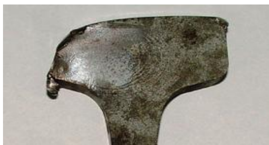
Figura 14. Desgaste num dos lados da cabeça do carril
