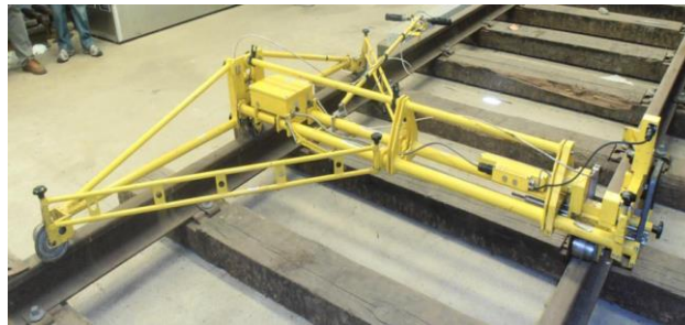
Figura 18. KRAB Light (auscultador de geometria de via da REFER)
